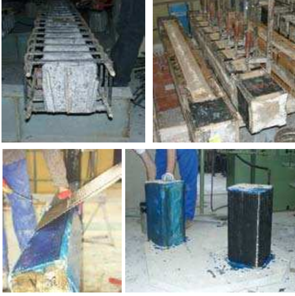
Şekil 27. Betonarme, çelik ve lifli polimer sargılama ile güçlendirilmiş laboratuvar numuneleri
