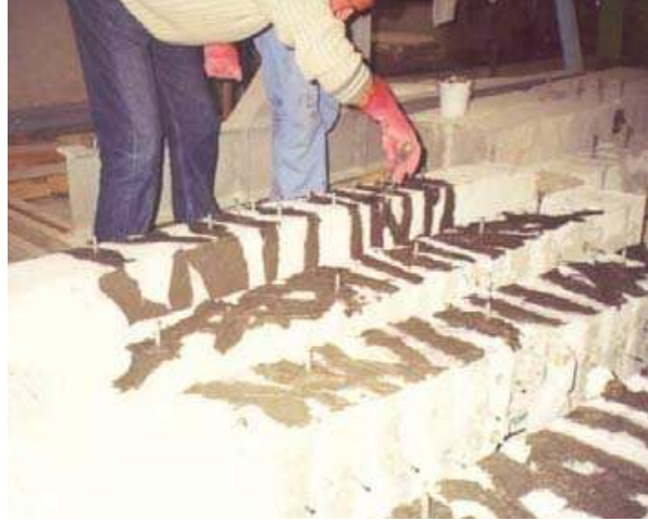
Şekil 26. Epoksi enjeksiyonu ile onarılan laboratuvar numuneleri
